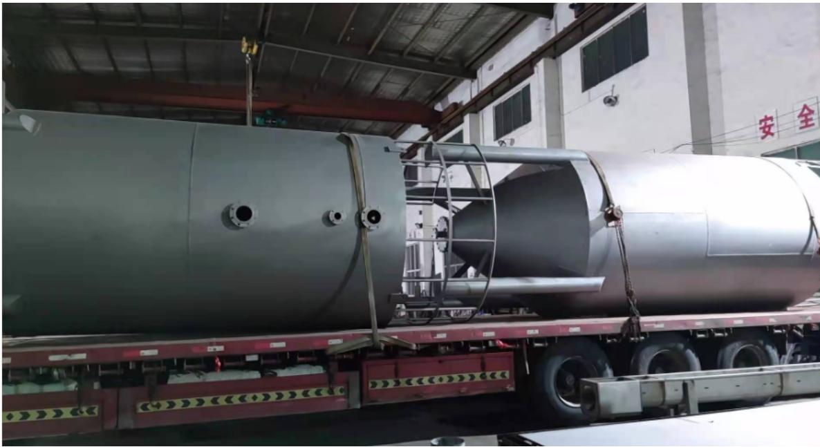
在水质预处理系统中，活性炭过滤器能够吸附前级过滤中无法去除的余氯以防止后级反渗透膜受其氧化降解，同时还吸附从前级泄漏过来的小分子有机物等污染性物质，对水中异味、胶体及色素、重金属离子等有较明显的吸附去除作用，还具有降低COD的作用。可以进一步降低RO进水的SDI值，保证 $SDI < 5$ 且 $TOC < 2.0 \text{ppm}$
