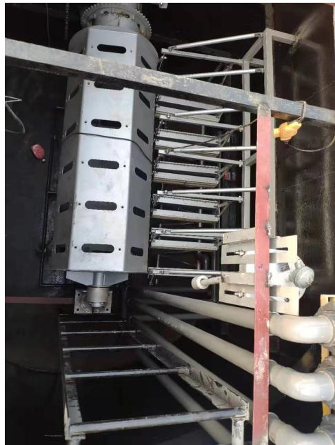
活性炭滤床分为固定床、移动床和流动床三种。固定床活性炭过滤应用较普遍，国内已用于给水的活性炭滤池、污水的深度处理，主要用于脱色，除臭，脱氰，去除有机物、重金属、合成洗涤剂、病毒等。固定炭层厚度 $1.5\text{--}2.0\text{m}$ 过滤速度 $8\text{--}20\text{m/h}$ 反冲洗水速度 $28\text{--}32\text{m/h}$ 反冲洗时间 $4\text{--}10\text{min}$ 活性炭失去其吸附能力后可采用直接电流加热再生，每千克炭再生费用约占新炭费用的5.5%，此外，可采用湿式氧化及微波加热等方法用于其再生，再生回，收率可达80~94%。
